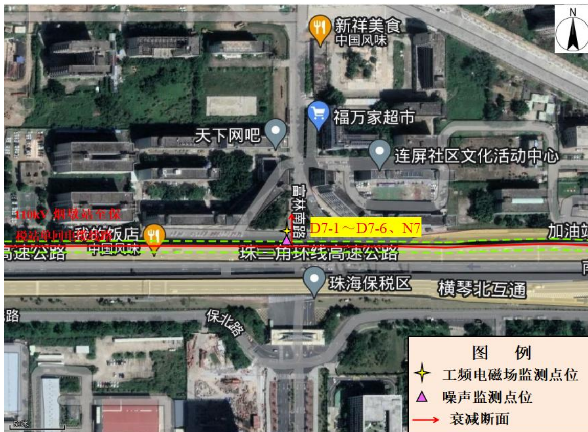
图 8-4 电缆衰减断面监测布点示意图
